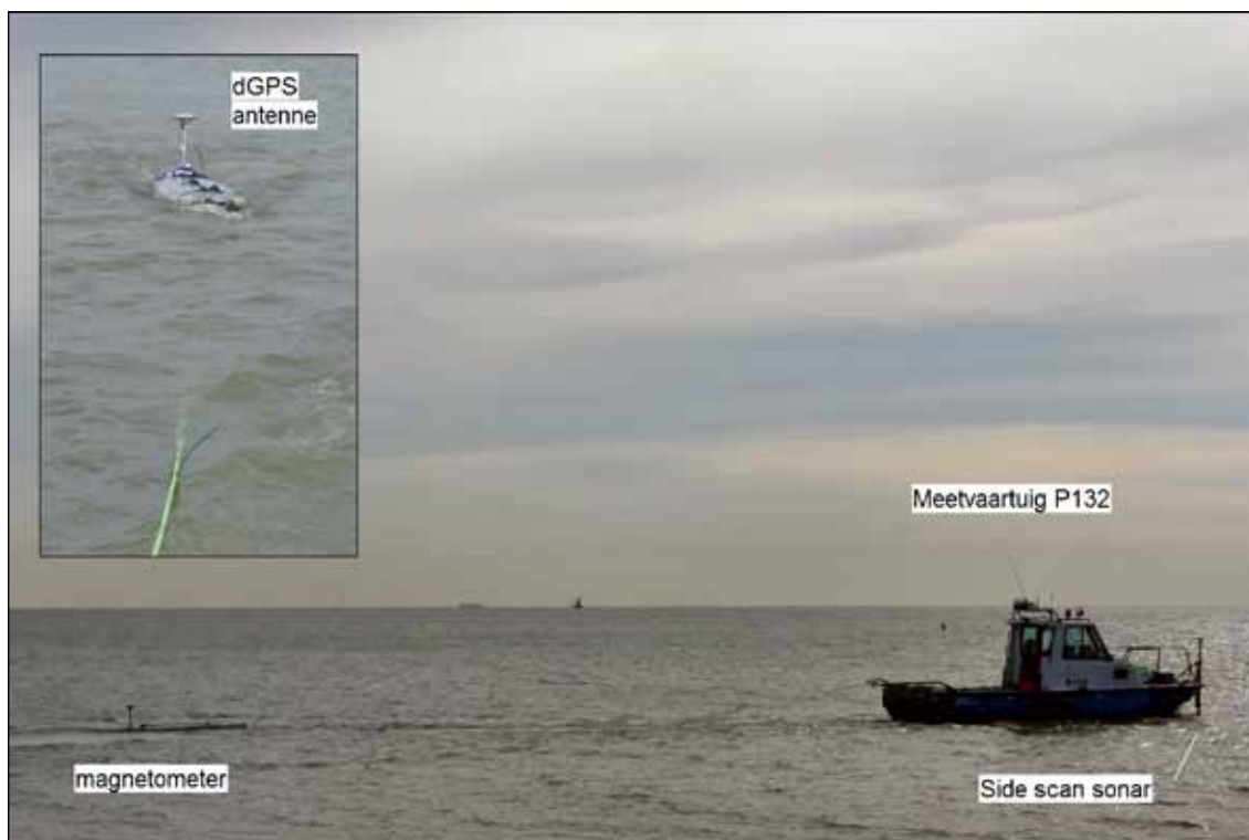
Afb. 10.1 Het meetvaartuig P132 met sonar en magnetometer.
