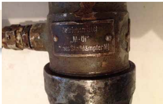
Af. 9 Deel schokdemper; gebruiksmiddel 'M-Olie'; groene schokdemperolie
